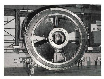
Bild 4 Straflo-Turbine: vierflügeliges Laufrad (Durchmesser 7,6 m) mit Generatorpolen nach Werkmontage (Bild Sulzer Hydro).
