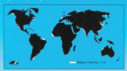
Mögliche Standorte von Gezeitenkraftwerken (Quelle HEA).
