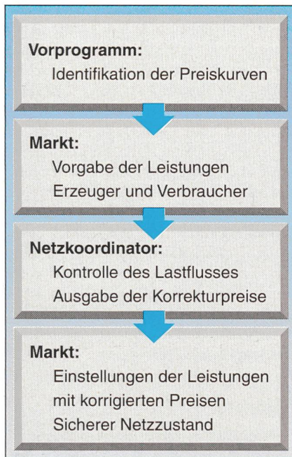
Bild 4 Flussdiagramm für die Einflussnahme eines Koordinators zur Beseitigung einer Überlast in einem Netz
