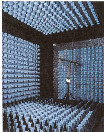
Die Absorberhalle für Störfestigkeit des SEV erlaubt, das Verhalten von Geräten unter dem Einfluss von elektromagnetischen Feldern im Frequenzbereich von 26 MHz bis 1 GHz zu prüfen.
