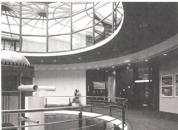
Bild 2 Das Tageslichtangebot wird optimal genutzt. Sowohl grosse Fensterflächen als auch der glasüberdachte Innenhof lassen viel Licht in das Gebäudeinnere fließen. Das flexible Lichtmanagementsystem stimmt das natürliche Licht mit dem Kunstlicht laufend ab.
