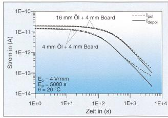
Bild 7 Gemessene Relaxationsströme von geschichteten, inhomogenen Isolieranordnungen
