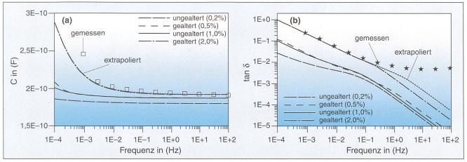
Bild 6 Frequenzabhängigkeit von Kapazität und Verlustfaktor von Board-Proben
