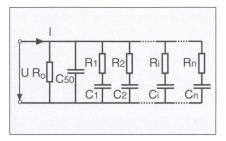
**Bild 5 Simulation gemessener Relaxationsströme**Allgemeine Ersatzschaltung eines verlustbehafteten Isoliersystems zur Simulation der gemessenen Relaxationsströme; Bedeutung der Schaltelemente, siehe Text.
