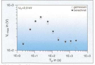
Bild 12 Das aufgrund einer Ersatzschaltung simulierte sowie das mit einem RVM-Gerät gemessene Polarisationsspektrum des Transformators von Bild 10
