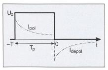
Bild 2 Relaxationsströme in einem Isolierstoff Prinzipieller, zeitlicher Verlauf der Relaxationsströme  $I_{pol}$  und  $I_{depol}$  während und nach einer Polarisationsdauer  $T_p$ .
