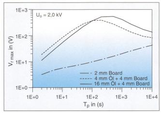
Bild 9 Vergleich der simulierten Polarisationsspektren für die ungealterte, homogene Board-Probe von Bild 4 a mit jenen der beiden geschichteten Isolieranordnungen von Bild 7
