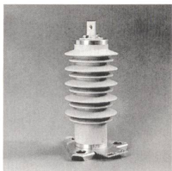
Unser stärkster Mittelspannungsableiter: Ein POLIM-H der IEC-Klasse 4 für 4 bis 52 kV (hier 18 kV) mit 12 kJ/kV UC für stärkste Beanspruchungen.
