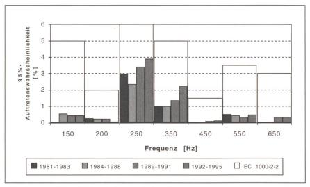
Bild 2 Gemessene Werte der Oberschwingungen in den MS-Netzen.
