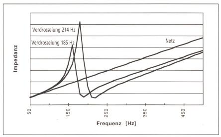
Bild 3 Impedanzverlauf von verdrosselten Kompensationsanlagen.
