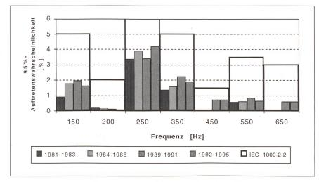
Bild 1 Gemessene Werte der Oberschwingungen in den NS-Netzen.
