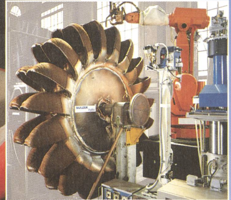
▲ Fertigung eines Pelton- Laufrades im MicroGuss- Verfahren
