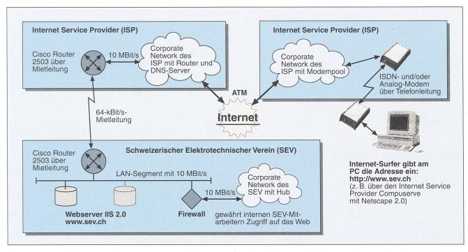
Bild 1 Schematische Darstellung des Webservers www.sev.ch mit Zugang zu einem Internet Service Provider über eine 64-kbps-Mietleitung.
