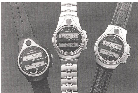
Drei Modelle der ersten Armbanduhr, die Radioaktivität und Röntgenstrahlen misst: 12 mm hohes Gehäuse, von einem italienischen Designer entworfen. Die Preise reichen von 1650 bis 2550 Fr.
