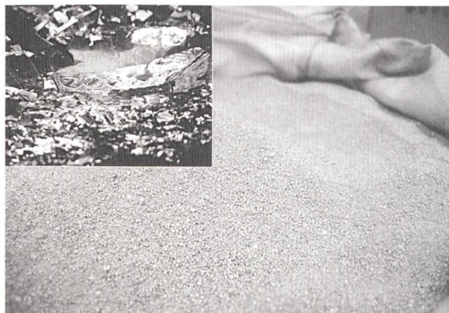
Aus Produktionsabfällen von Verbundstoffmaterialien (kleines Bild) kann Aluminium hoher Reinheit zur Wiederverwendung extrahiert werden.
