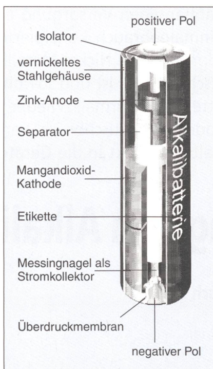
Bild 1 Prinzipieller Aufbau einer Alkalibatterie
