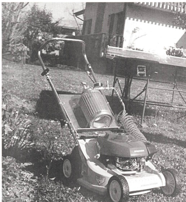
Bild 7 Wasserstoff-betriebener Rasenmäher mit aufmontiertem zylindrischem Metallhydrid-Wasserstoff-speicher
