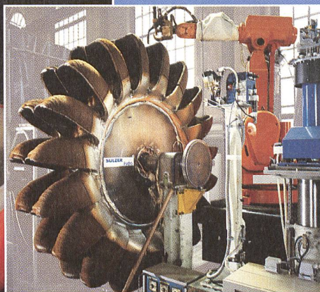
▲ Fertigung eines Pelton-Laufrades im MicroGuss-Verfahren
