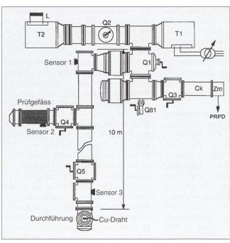
Bild 1 Prinzip eines konventionellen Teilentladungsmesskreises
