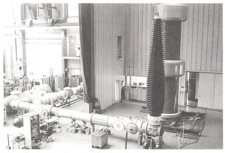
Bild 3 Prüfanlage mit angeschlossener Durchführung
