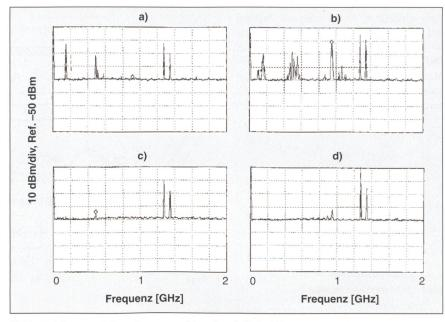
Bild 7 Hochfrequente Störer – Frequenzspektrum innerhalb der GIS
