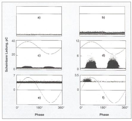
Bild 8 Messresultate mit der Breitband-UHF-Methode
