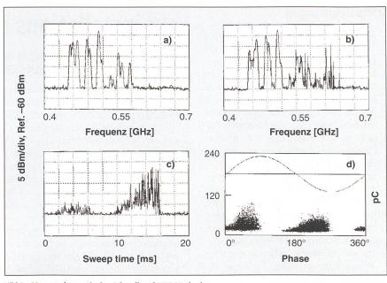
Bild 9 Messresultate mit der Schmalband-UHF-Methode
