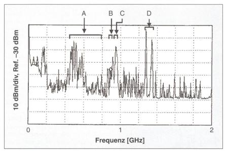
Bild 6 Typisches Frequenzspektrum, gemessen ausserhalb der GIS
