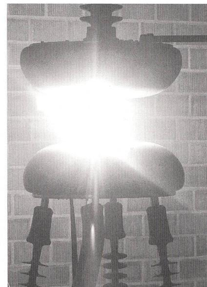
Elektrische Überschläge und Lichtbögen dürfen in elektrischen Anlagen – sofern überhaupt – nur an den dafür bestimmten Stellen auftreten, da sie sonst verheerende Schäden verursachen.
