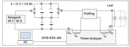
Bild 1 Blockschema der Wechselrichter-Testanlage.
