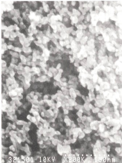
Bild 5 Rasterelektronenmikroskopische Aufnahme eines nanokristallinen \text{TiO}_2 -Filmes
