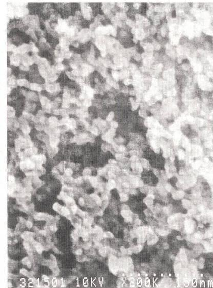
In neuartigen Solarzellen findet der photoelektrische Effekt an der Oberfläche eines porösen  $\text{TiO}_2$ -Filmes statt. Die Korngrösse der auf der elektronenmikroskopischen Aufnahme sichtbaren Sinterteilchen dieses Filmes beträgt 10-30 Nanometer (siehe Seite 11).
