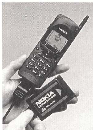
Datenfernübertragung mittels PCMCIA-Karte und Handy
