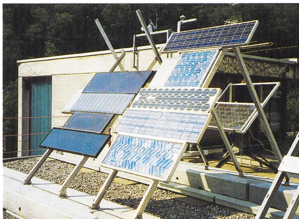
Verschiedene Photovoltaik-Zellentypen bei der Erprobung.
