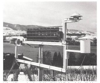
Prüfstand für neuartiges doppelseitiges PV-Modul. Ein doppelseitiges Modul wird mit speziellen Zellen realisiert, die einfallendes Licht sowohl auf der Vorder- als auch auf der Rückseite in Elektrizität umwandeln können. Installiert man ein solches Modul vertikal, längs der Nord-Süd-Richtung, so wird die Vormittags- und Nachmittagssonne zur Stromerzeugung genutzt (Bild TNC).
