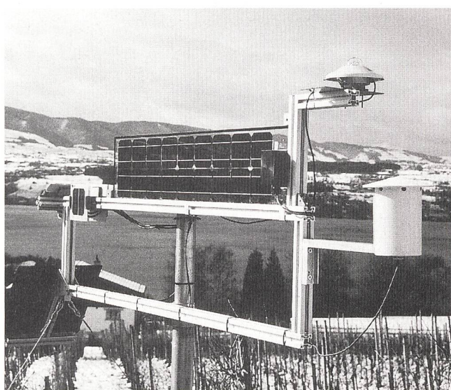
Prüfstand für neuartiges doppelseitiges PV-Modul. Ein doppelseitiges Modul wird mit speziellen Zellen realisiert, die einfallendes Licht sowohl auf der Vorder- als auch auf der Rückseite in Elektrizität umwandeln können. Installiert man ein solches Modul vertikal, längs der Nord-Süd-Richtung, so wird die Vormittags- und Nachmittagssonne zur Stromerzeugung genutzt (Bild TNC).
