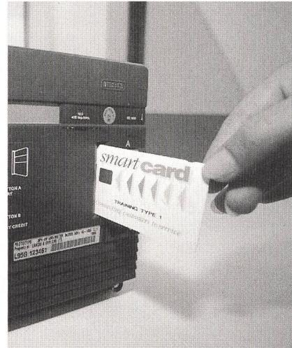
Chipkarten halten auch im Energieversorgungsbereich Einzug. Sie ermöglichen den Austausch von Daten zwischen Energieleverant und Energiebezüger und dienen u.a. als Basis für eine einfache Verrechnung des Energiebezugs (siehe Seite 33).
