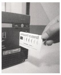
Chipkarten halten auch im Energieversorgungsbereich Einzug. Sie ermöglichen den Austausch von Daten zwischen Energielieferant und Energiebezüger und dienen u.a. als Basis für eine einfache Verrechnung des Energiebezugs (siehe Seite 33).
