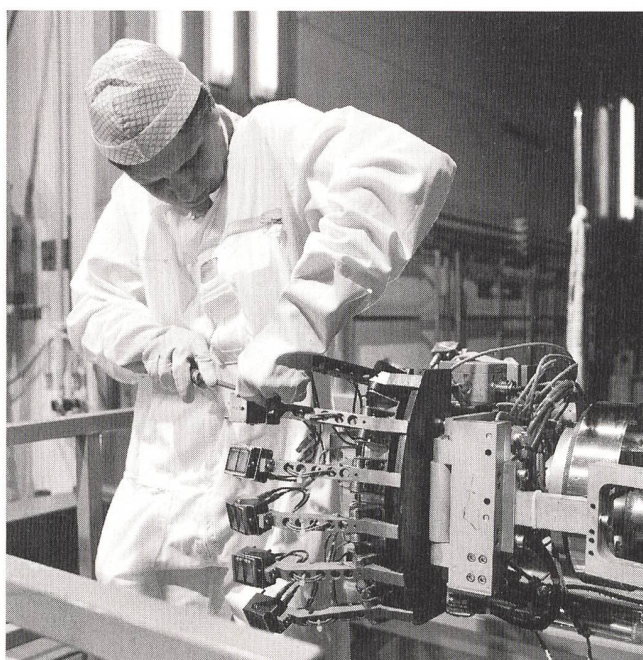
Revisionsarbeiten: Montage der Ultraschallprüfköpfe.
