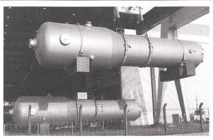
Dampferzeuger mit je 360 Tonnen Gewicht: Für das schwedische Kernkraftwerk Ringhals 3 (Leistung 915 MW) hat das deutsch-französische Konsortium Siemens/Framatome drei neue Dampferzeuger gebaut und ausgeliefert. Die Dampferzeuger sind für eine Leistungssteigerung von etwa 12% ausgelegt und werden im Laufe dieses Sommers installiert.
