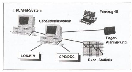
Bild 4 Beispiel für eine sinnvolle Integration im Gebäudemanagement
