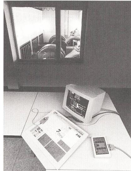
Die heutige Mikroprozessortechnik erlaubt, Schutz- und Steuersysteme von Kraftwerken und Elektrizitätsnetzen – unter Beibehaltung der Autarkie des Schutzes – weitgehend zu integrieren. Das Bild zeigt die hydraulische und elektrische Steuerung und den Schutz eines Wasserkraftwerks (siehe Seite 11).
