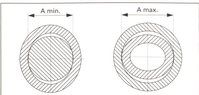
Zulässige Abweichungen des unbearbeiteten Buchsendurchmessers A min. oder des unbearbeiteten Steckerdurchmessers A max. bis maximal  $\pm 0,55\text{mm}$ , einschliesslich Unrundheit.
