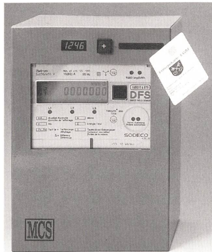
Bild 2 Die Chipkarte als bargeldloses Zahlungsmittel hat sich auch bei der Energieverrechnung erfolgreich durchgesetzt. Die Bedienung der elektronischen Zahlautomaten ist einfach und selbsterklärend (Werkbild Egro AG).
