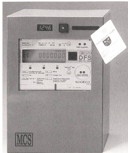
Bild 2 Die Chipkarte als bargeldloses Zahlungsmittel hat sich auch bei der Energieverrechnung erfolgreich durchgesetzt. Die Bedienung der elektronischen Zahlautomaten ist einfach und selbsterklärend (Werkbild Egro AG).
