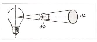
Bild 3 Beziehung zwischen Beleuchtungsstärke und Lichtstrom.
