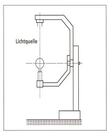
Bild 4 Schemaskizze des Lichtstromgoniometers.
