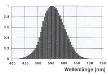
Bild 2 Normierter spektraler Hellempfindlichkeitsgrad (y-Achse) des menschlichen Auges V ( $\lambda$ ).
