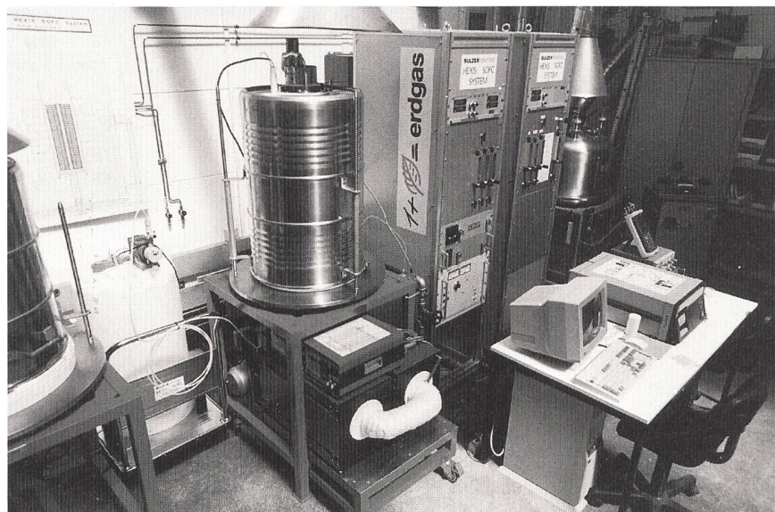
Bild 1 Im HEXIS-Messlabor im schweizerischen Winterthur: Links von der Bildmitte das wärmedämmende Gehäuse, das einen Stapel von 43 Festoxid-Brennstoffzellen enthält. Darunter die Hilfsanlagen: ein Ventilator für die Verbrennungsluft und ein externer Reformer für die Aufspaltung des Erdgases in Kohlenmonoxid und Wasserstoff, den eigentlichen Brennstoff. Rechts die elektronischen Einrichtungen zur Steuerung der Anlage (z. B. des Anfahrens über 8 Stunden) und für die Messungen. (Fotos: Sulzer-Innotec)
