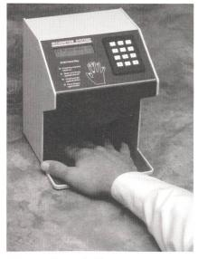
Bild 2 Handgeometrie-Erkennungsgerät
