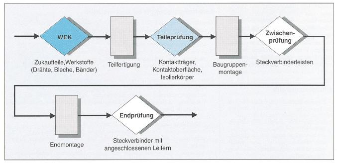
Bild 3 Fertigungsprüfablauf
