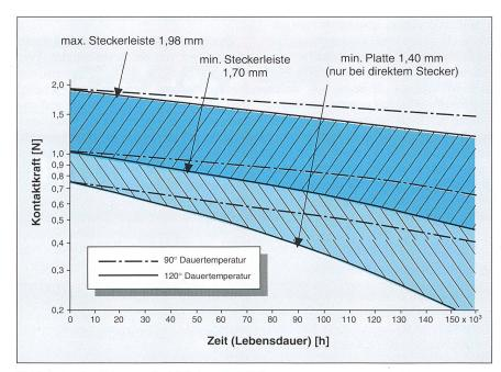
Bild 2 Langzeitverhalten von Kontaktfedern aus CuNi<sub>9</sub>Sn<sub>2</sub>
