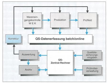
Bild 5 Rechnergestützte integrierte Qualitätssicherung: WEK, Produktion, Prüffeld
