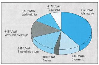
Diagramm 4 Stromgestehungskosten der PV-Anlage «Kirche Steckborn» Baujahr 1993, Nominalleistung 19,44 kW<sub>p</sub>, Jahresertrag 11,02 MWh, Investitionskosten 448,00 kFr., Annuität 7,1% pro Jahr, Betrieb und Unterhalt 1,0% pro Jahr, Stromgestehungskosten 3,29 Fr./kWh
