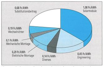
Diagramm 5 Stromgestehungskosten der PV-Anlage «Migros Winterthur» Baujahr 1994, Nominalleistung 66,30 kWp, Jahresertrag 35,68 MWh, Investitionskosten 988,67 kFr., Annuität 7,1% pro Jahr, Betrieb und Unterhalt 1,0% pro Jahr, Stromgestehungskosten 2,24 Fr./kWh
