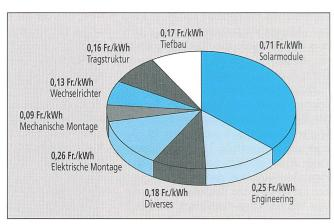
Diagramm 3 Stromgestehungskosten der PV-Anlage «Caischavedra» Baujahr 1993, Nominalleistung 97,89 kW<sub>p</sub>, Jahresertrag 120,60 MWh, Investitionskosten 2897,00 kFr., Annuität 7,1% pro Jahr, Betrieb und Unterhalt 1,0% pro Jahr, Stromgestehungskosten 1,94 Fr./kWh
