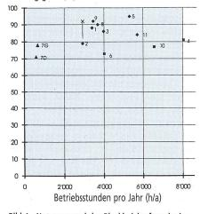
Bild 1 Nutzungsgrad der Blockheizkraftwerke in Abhängigkeit der Betriebsstunden pro Jahr
