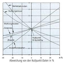
Nullpunkt: 18 Rp./kWh<sub>e</sub> Zinssatz 7% Nutzungsdauer 15 a Betriebsstunden pro Jahr 4000 h Wartungskosten 3,5 Rp./kWh Gaspreis 3,5 Rp./kWh Investitionskosten 4000 Fr./kWe
