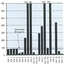
Bild 6 NO<sub>x</sub>-Emissionen (Momentanmessung bei warmem Motor, ohne Berücksichtigung des Anlaufvorgangs). Mehrfachangaben der gleichen Anlage bedeuten Messungen, die mindestens ein Jahr auseinanderliegen
