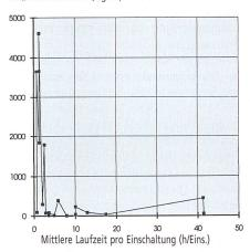
Bild 7 Zusammenhang zwischen NO<sub>x</sub>-Emissionen (ermittelt aus Momentanmessungen im stationären Betrieb) und mittlere Laufzeit pro Einschaltung. Je Anlage wurden zum Teil mehrere Messungen berücksichtigt
