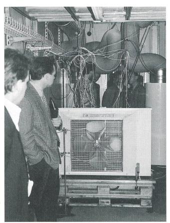
Bild 5 Testinstallationen einer Luft/Wasser-Wärmepumpe in der Klimakammer (Kaltzelle)
