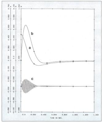
ist auch der transformatorische Effekt berücksichtigt. Die Gleichstromglieder der elektrischen Maschinen sowie der Backswingeffekt der Polradwinkel sind deshalb ebenso wie die Pendelmomente richtig abgebildet. Diese Art der Modellbildung erlaubt eine sehr genaue Simulation der dynamischen Vorgänge im Netz.
