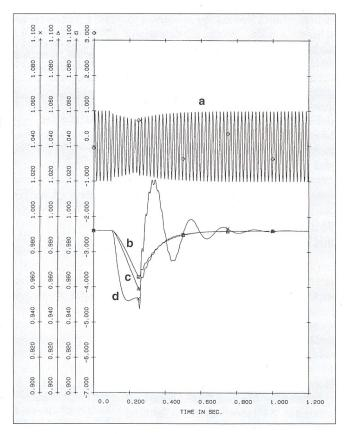
Bild 7 Betriebsverhalten eines 30-MW-Gasturbinengenerators beim Synchronisieren mit Anfangsschlupf
