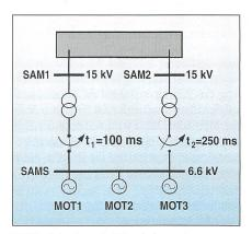
Bild 5 Netzschema bei Umschaltung einer Motorengruppe
