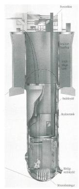
Aussergewöhnliche Arbeiten im Reaktordruckbehälter: dazu wurden unter anderem Strahlschutzzylinder und ein spezieller Personenaufzug eingebaut
