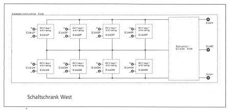
Bild 5 Blockschema einer Hochspannungs-Sammelschiene
