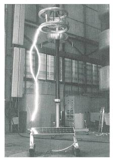
Bild 7 Test der neuentwickelten ISB-Miniatur-Blitzfänger im Hochspannungslabor: Einschlag eines Blitzes von etwa 3 m Länge und rund 2 MV Spitzenspannung in ein mit ISB-Blitzfängern geschütztes Solarmodul bei der Firma Emil Haefely AG, Basel. Zum Vergleich: Im neuen ISB-Hochspannungslabor können Blitze von etwa 1 m Länge und 1 MV erzeugt werden
