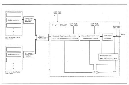
Bild 1 Blockschema der 60-kW-Wechselrichter-Testanlage der ISB
