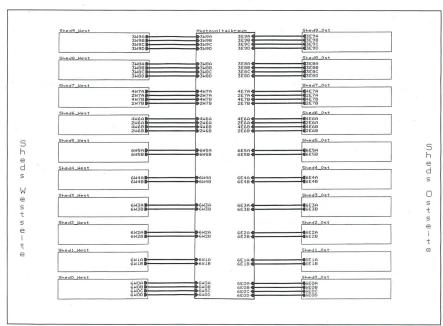
Bild 4 Prinzip der Verkabelung zwischen Arrayanschlusskästen und PV-Schaltraum
