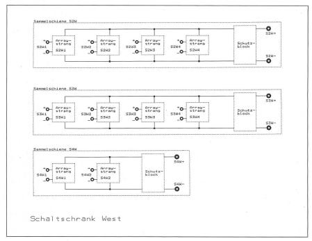
Bild 6 Blockschema der übrigen Sammelschienen
