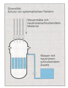
Bild 2 Zwei- oder mehrfach vorhandene (redundante) Systeme könnten aus einer einzigen Ursache heraus gleichzeitig ausfallen, zum Beispiel infolge von gleichen Konstruktionsmängeln oder Fertigungsfehlern. Um sich davor zu schützen, arbeiten die einzelnen Systeme nach verschiedenartigen (diversitären) Prinzipien. Fallen zum Beispiel die Steuerstäbe aus, so tritt sofort die Wassereinspeisung in Aktion, die die Kettenreaktion zum Stillstand bringt
