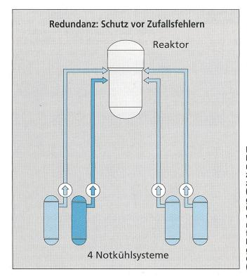
Bild 1 Die einfachste Methode, eine technische Grundsicherheit zu erreichen, ist die zwei- oder mehrfache (redundante) Installation gleicher Systeme oder Geräte, die unabhängig voneinander funktionieren. So sind zum Beispiel für die Notkühlung eines Reaktors vier Kühlstränge installiert, obwohl einer ausreichen würde (Bilder Siemens)
