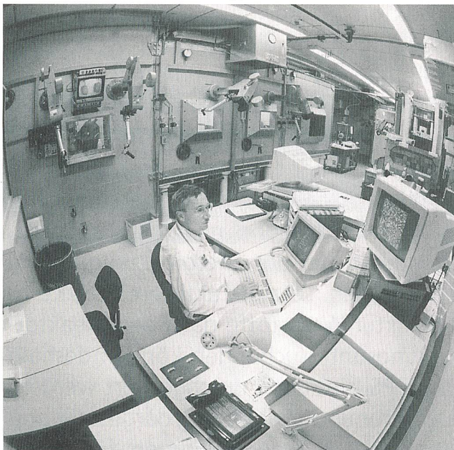
Bild 2 Mit Hilfe der abgeschirmten Elektronenmikrosonde kann an geschliffenen, hochaktiven Proben auf kleinster Fläche (etwa 1 Quadrat-Mikrometer) die chemische Zusammensetzung ermittelt werden. Das moderne oberflächenanalytische Messgerät (das kleine Bild ermöglicht einen Blick hinter die Abschirmung) ist von einem Prozessrechner gesteuert. In den Abschirmungen im Hintergrund werden die Proben für die Mikrosonde und weitere Geräte vorbereitet
