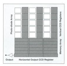
Bild 6 Schaltungsarchitektur eines Rahmen-Zwischenzeilen-Transfer-Bildsensors
