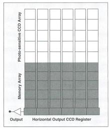
Bild 4 Schaltungsarchitektur eines Rahmen-Transfer-Bildsensors
