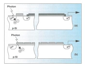
Bild 2 Kopplung der Photodiode mit der Aussenwelt
