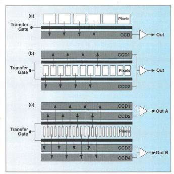
Bild 3 Schaltungskonzepte verschiedener linearer Image-Sensortypen
