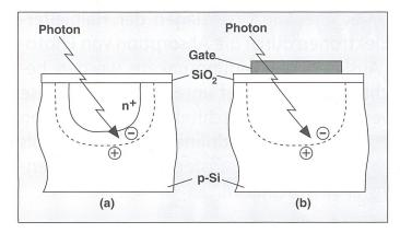
Bild 1 Zwei mögliche Photonkonversionsschaltungen a. physikalischer
