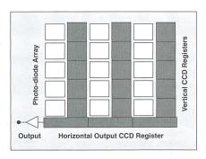
Bild 5 Schaltungsarchitektur eines Zwischenzeilen-Tranfer-Bildsensors
