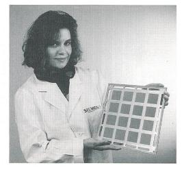
Bipolare Platte mit Brennstoffzellen
