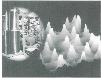
Flusslinien eines Supraleiters, aufgenommen mit dem Tieftemperatur-Raster-Magnetkraftmikroskop
