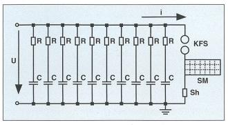
Bild 1 Schema des Stossstromgenerators der ISB siehe [1]
