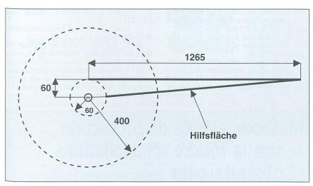
Bild 9 Zur Berechnung der Gegeninduktivität verwendete Hilfsebene
