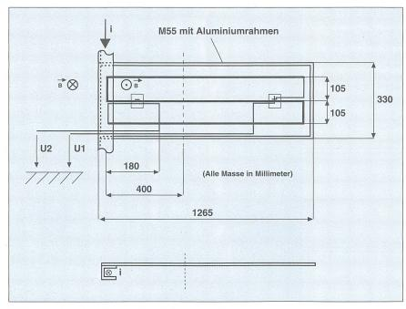
Bild 8 Testanordnung zur Bestimmung der Gegeninduktivität
