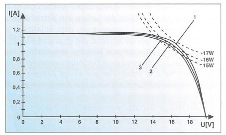
Bild 3 Kennlinien eines PV-Moduls
