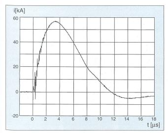
Bild 10 Stossstrom zur Bestimmung der Gegeninduktivität
