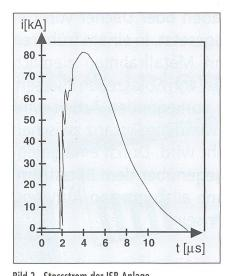
Bild 2 Stossstrom der ISB-Anlage Typischer Verlauf eines mit dem ISB-Generator erzeugten Stossstromes mit  $I_{max}$  = 80 kA und di/dt = 53 kA/µs [1].
