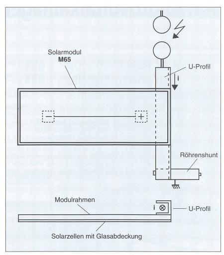
Bild 4 Testanordnung mit erhöhter Distanz zwischen Strompfad und Solarzellen
