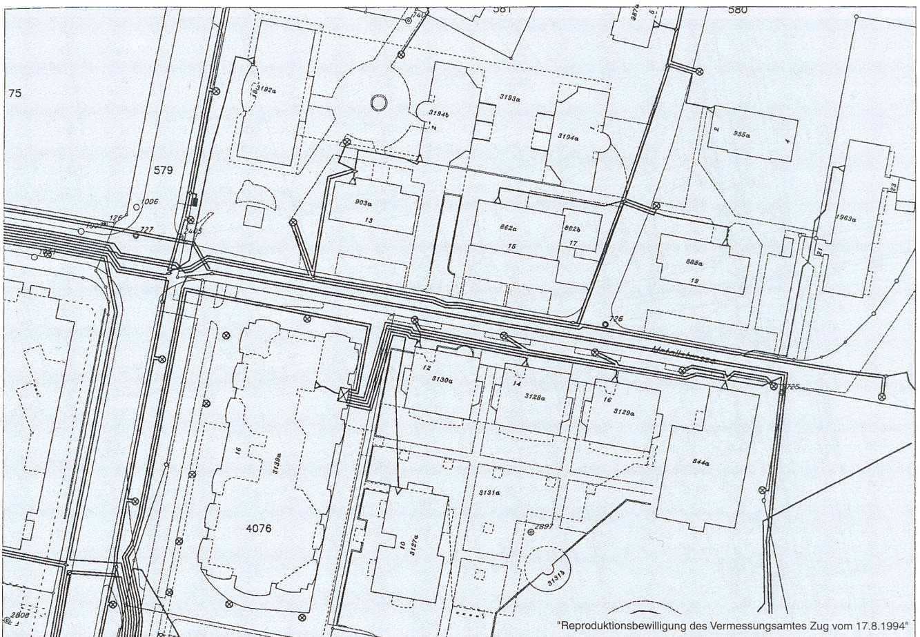
Bild 7 Ausschnitt aus einem Kabelschemaplan eines elektrischen Verteilnetzes
