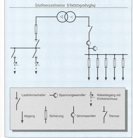
Bild 4 Stationsschemata ergänzen die anlagenexterne netzlogische Beschreibung zu einem vollständigen Prinzipschema
