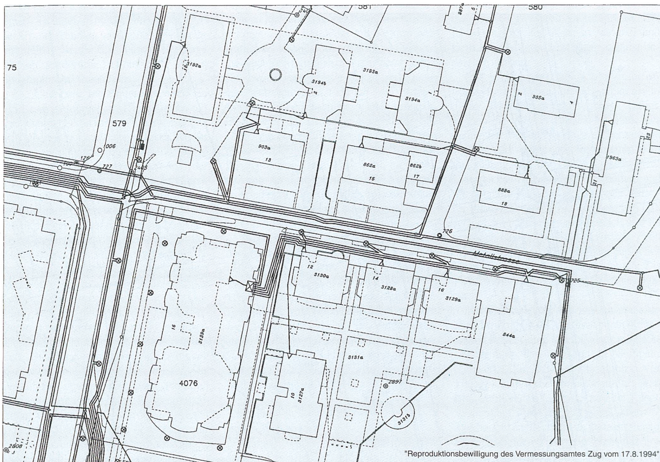
Bild 7 Ausschnitt aus einem Kabelschemaplan eines elektrischen Verteilnetzes
