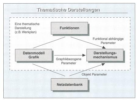
Bild 5 Zusammenhang zwischen Datenmodell, Darstellung und Funktionen
