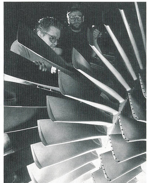
106-MW-Gasturbine von Siemens: Im laufendem Betrieb sind die Schaufeln Verbrennungsgasen bis zu 1400°C ausgesetzt
