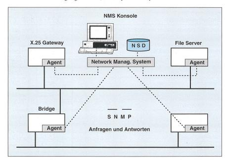
Bild 5 SNMP: das zentrale Management-Modell
