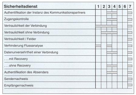
Bild 3 Sicherheit in ISO/OSI
