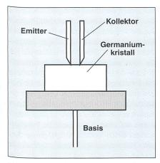
Bild 5 Aufbau des Spitzentransistors (1948)
