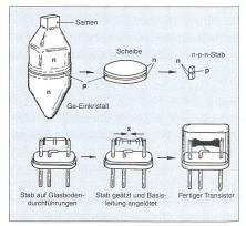
Bild 8 Gezogener Ge-Schichtkristall und gezogener Transistor (1954)
