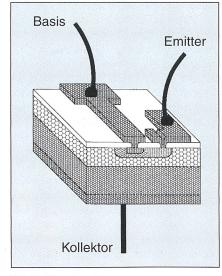
Bild 10 Planartransistor
