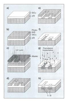
Bild 9 «Planares» Herstellungsverfahren von P-N Übergängen
