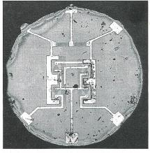
Bild 12 Chip-Photo der ersten kommerziell erhältlichen integrierten Schaltung
