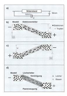
Bild 6 Elektrische Leitung in Halbleiterkristallen
