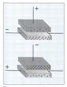
Bild 4 Kapazitiv gesteuerte Kondensatorplatte als leistungsarm steuerbarer Widerstand (Verstärker), O. Heil 1935
