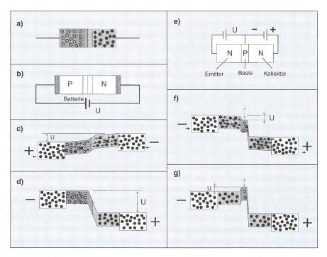
Bild 7 P-N-Diode und N-P-N-Transistor
