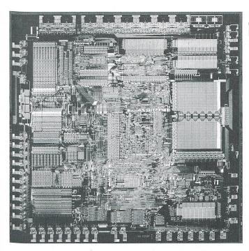
Bild 14 Chip-Photo des 16-Bit-Mikroprozessors 80286 Photo Siemens
