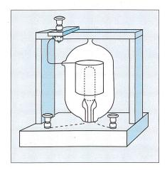
Bild 2 Skizze eines frühen experimentellen Gleichrichters
