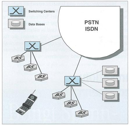
Bild 1 Struktur eines Mobilfunknetzes
