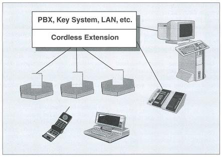
Bild 3 Struktur eines schnurlosen Telefonsystems
